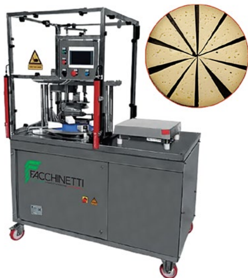
Машина для порціонування круглих сирів із точною вагою PR01
