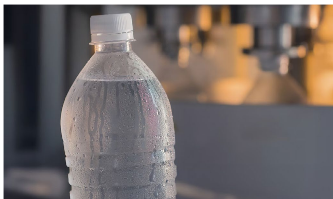
Досі контейнери потрібно було охолоджувати перед наповненням, а потім знову нагрівати, щоб запобігти конденсації. Рішення LCS Warmfill тепер покладає край цій втраті енергії
